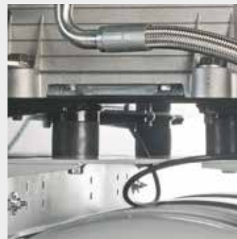
Base del motor/unidad instalada sobre 4 amortiguadores de goma antivibratorios para reducir las vibraciones, reducir el ruido y alargar la vida útil (sólo en los modelos Diésel)
